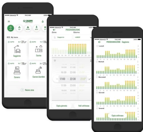
La comunicazione tra dispositivi avviene tramite onde radio ed è il Gateway, il cervello dell'intero sistema, che interagendo tramite rete internet con la app CALEFFI CODE®, controlla e gestisce il riscaldamento dell'abitazione secondo la programmazione e le esigenze dell'utente, comunicando con comandi e sensori.
