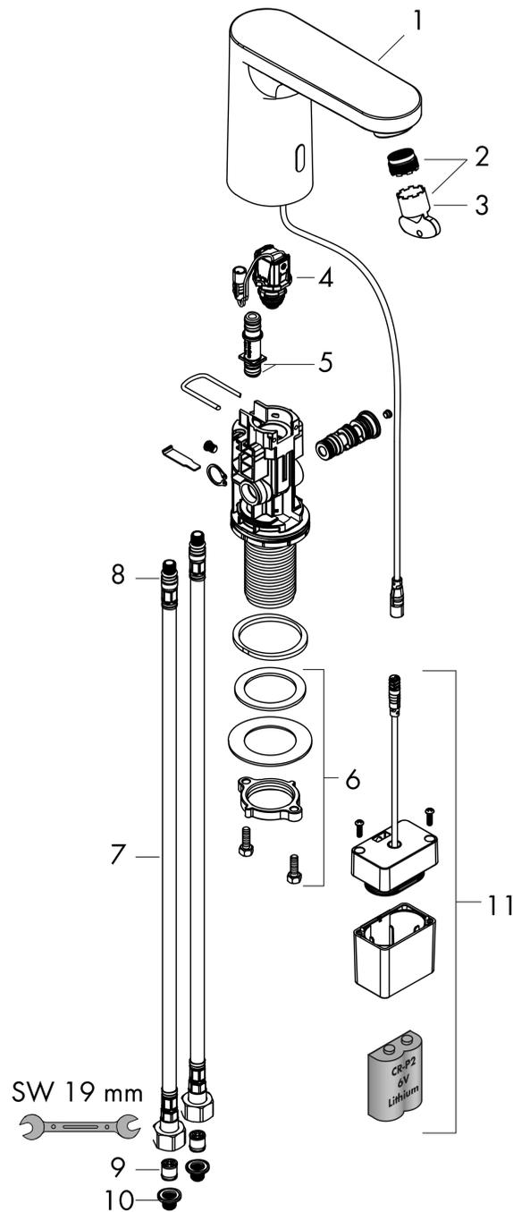
**Vernis Blend****Miscelatore lavabo elettronico con regolazione della temperatura, funzionamento a batteria**Finiture: **Cromo** Cod.art. : **71502000**
