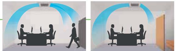
Distribuzione confortevole dell'aria con l'attivazione simultanea di effetto swing ad evitare il flusso diretto di aria fredda.
