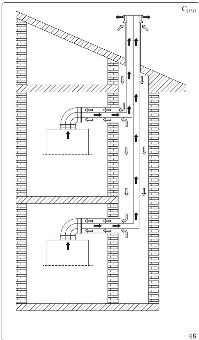
L'installazione in configurazione C<sub>(15)3</sub> di un apparecchio Immergas, permette di effettuare l'aspirazione dall'aria comburente direttamente dal cavedio dove è presente lo scarico dei fumi in canna fumaria dedicata.
