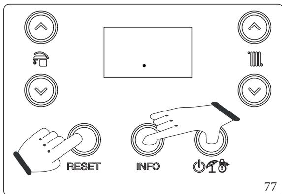
La funzione si attiva da caldaia in "off" premendo e mantenendo premuto per più di 5 secondi i pulsanti "RESET", "INFO" e "⏻⚡".
