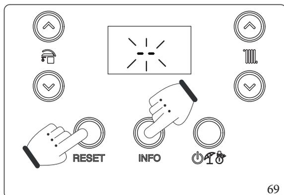
Per accedere alla fase di programmazione occorre premere e mantenere premuto per un tempo maggiore di 5 secondi i pulsanti "RESET" e "INFO", sul display compaiono due linee "--" lampeggianti ed è necessario inserire la password (69) per l'accesso ai menù di programmazione.
