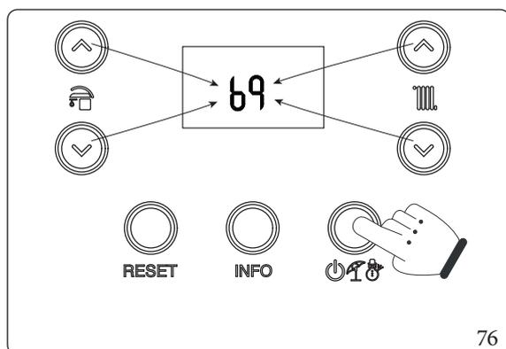
Per inserire la prima cifra utilizzare i pulsanti per la regolazione dell'acqua sanitaria "6", per inserire la seconda cifra utilizzare i pulsanti per la regolazione temperatura riscaldamento "9".
