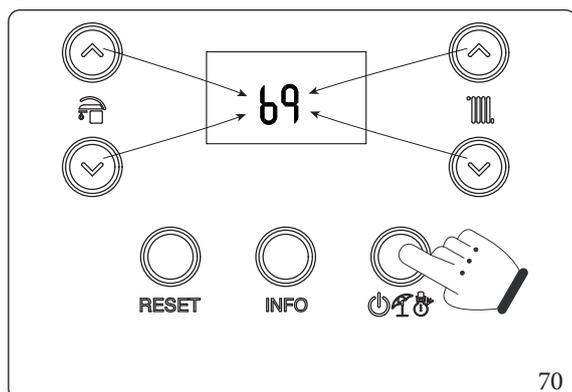
Per inserire la prima cifra utilizzare i pulsanti per la regolazione dell'acqua sanitaria "6", per inserire la seconda cifra utilizzare i pulsanti per la regolazione temperatura riscaldamento "9".
