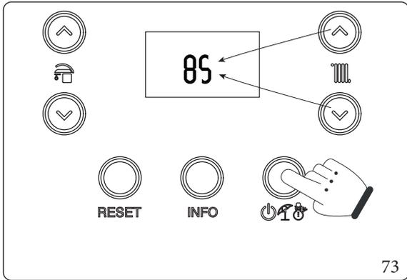
Premendo il pulsante modo di funzionamento "☰☑☑" viene visualizzato il valore del parametro selezionato e mediante i pulsanti per la regolazione temperatura riscaldamento "☰☑☑" è possibile regolarne il valore.
